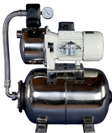
Groupes hydrophores , cuve acier ou inox de 20l. Débit de 50 à 160 l /mn. Tous voltages
