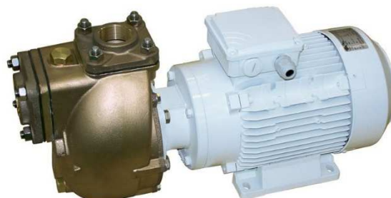
Electropompes série AM . Corps bronze et arbre inox . Pour eau moyennement chargée. Tension 24V/230/400V. Débit de 450 à 1500l/mn
